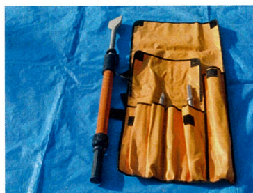
携帯用コンクリート破砕器具
