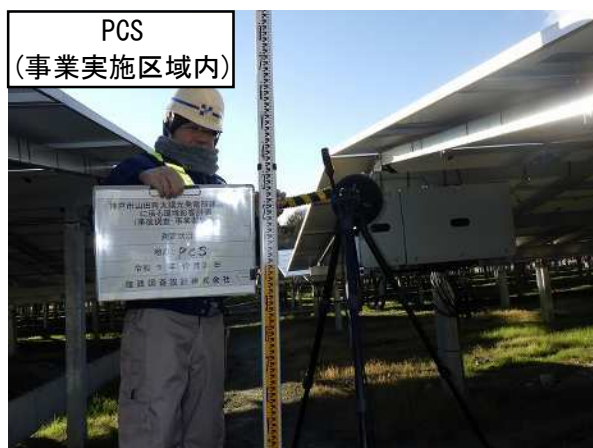
写真 3.1-1 調査の実施状況（施設稼働に伴う騒音・低周波音）（令和5年12月21日撮影）
