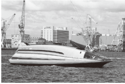
超電導電磁推進船「ヤマト1」(280 G/T)
